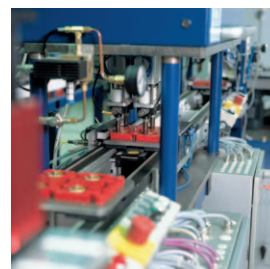
Produzione completamente automatica di manometri standard
